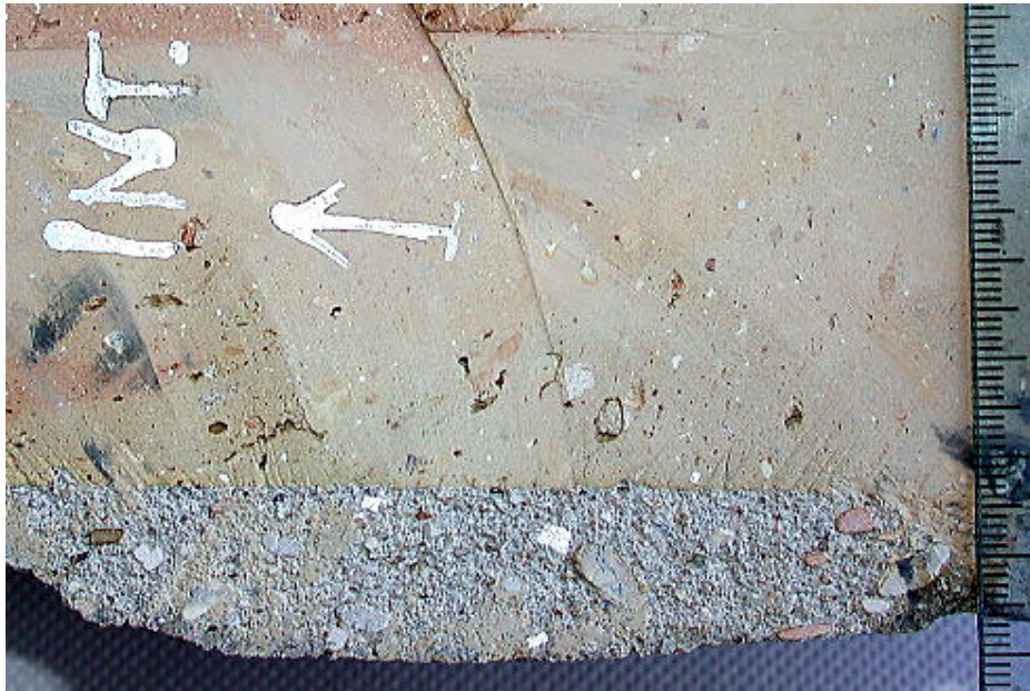
Foto n. 1 – Macrofotografia: si osserva colore d'insieme grigio chiaro, presenza di aggregati di colore variegato e “grumi bianchi”
