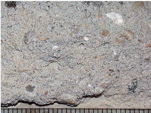
Foto n. 2 Macrofotografia: colore legante, e degli aggregati. Grumi bianchi (calcinarioli)
